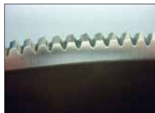
Mit dem Nachschleif-Service von TREIF erhält das Messer seine Verzahnung zurück. Die Mikro-Verzahnung wird nachgesetzt und nicht nur einfach geschliffen.
