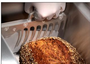
Die halbautomatische Brothalbierung ist besonders komfortabel. Sie müssen nur den Laib mittig platzieren. Anschließend teilt die Eazy das Brot und schneidet die Hälfte auf.
