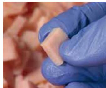
Con TWISAN pueden cortarse o rallarse productos en dados, tiras o láminas (láminas de 3 mm / 1/10" ver foto).
