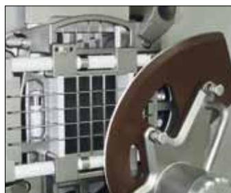
La technologie FlexRotationSystem permet d'adapter la vitesse de rotation du couteau au produit et à son application de manière optimale (100 à 400 tour/minute).
