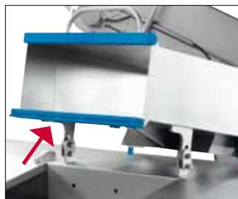
Высокий выход готовой продукции начинается с деталей: после транспортировки в воронку, блоки режутся разделительным ножом на куски с учетом размера резальной камеры. Образующиеся при этом остатки поступают обратно в резальную камеру через запатентованный коллектор для остатков (в нижнем конце воронки, см. указатель)
