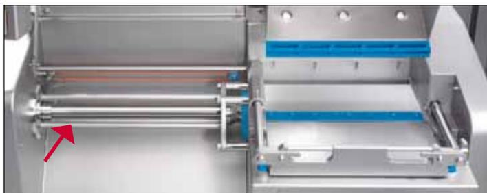
Благодаря открытой конструкции все ее элементы, даже гидравлический цилиндр подачи, легко доступны (см. указатель). Запатентованный цилиндр подачи, которым оснащен CASAN 200(серийно) также называется гигиеническим цилиндром, так как он делает загрязнение продукта гидравлическим маслом (в оборудовании TREIF применяется только гидравлическое масло для пищевой промышленности) технически невозможным. Масло не может попасть в резальную камеру.
