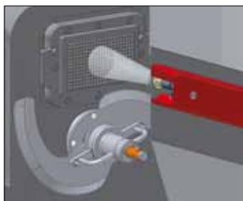
Для получения точных по размеру кубиков или брусочков, частота движения резака регулируется с помощью сенсоров. Результат — убедительно четкий рисунок на срезе. Техника резки с помощью сенсоров это один из патентов TREIF.
