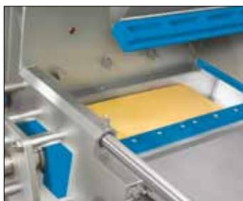
Сыр подается в автоматическом режиме с таким гидравлическим давлением, которое необходимо для высокой точности нарезки на основании заданных параметров. Эта технология обеспечивает бережное обращение с продуктом, а также более экономно использует энергию и гидравлическое масло по сравнению с обычными системами.
